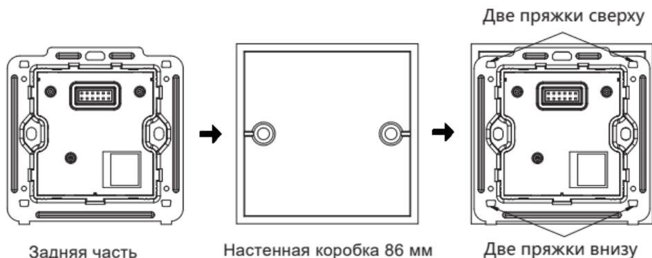
**Шаг 2:** Совместите переднюю часть настенной панели с розеткой в задней части настенной панели, затем одновременно нажмите на точку 1 и точку 2 (см. рисунок ниже) перпендикулярно стене, пока две пряжки сверху будут полностью застегнуты.
